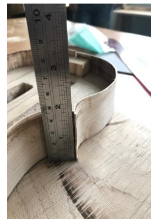
圖 9. 小提琴側板及表面呈現出的弧形及厚度，此側板之弧度與厚度參考 Guarneri。(龍暉製作、攝影)
