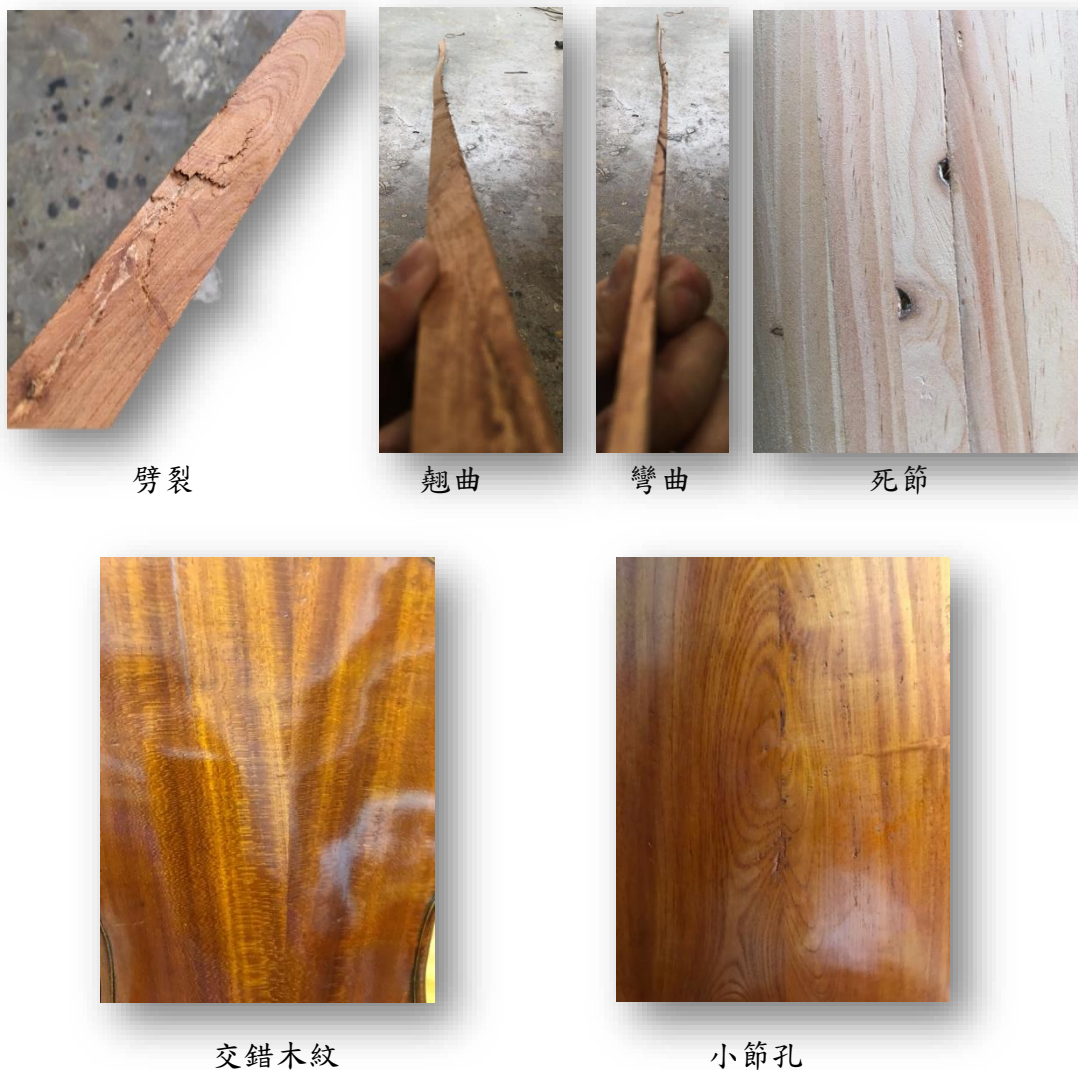
圖 35. 國產材漂流木經過乾燥處理後，二次加工過程中仍發生表面裂、翹曲等乾燥缺陷
