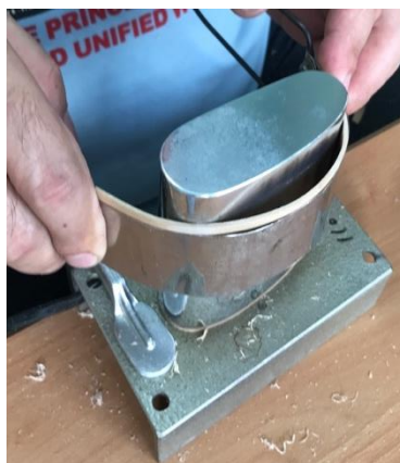
圖 9. 小提琴側板及表面呈現出的弧形及厚度，此側板之弧度與厚度參考 Guarneri。(龍暉製作、攝影)
