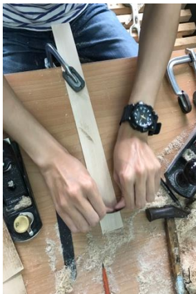
圖 9. 小提琴側板及表面呈現出的弧形及厚度，此側板之弧度與厚度參考 Guarneri。(龍暉製作、攝影)
