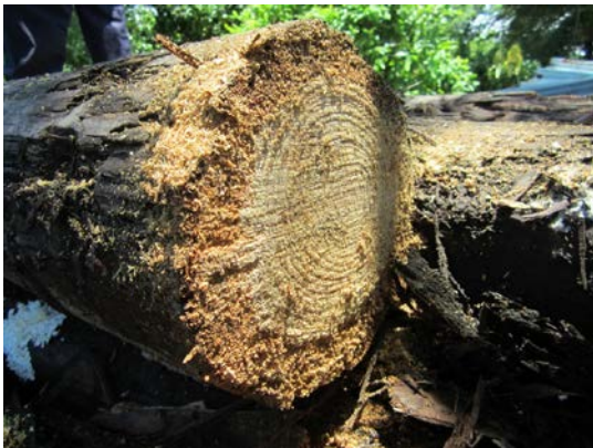
圖 21. 以鏈鋸鋸切後之橫斷面可見邊材已腐朽
