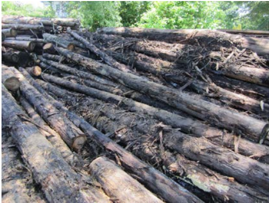
圖 19. 大部分木材表面腐朽嚴重
