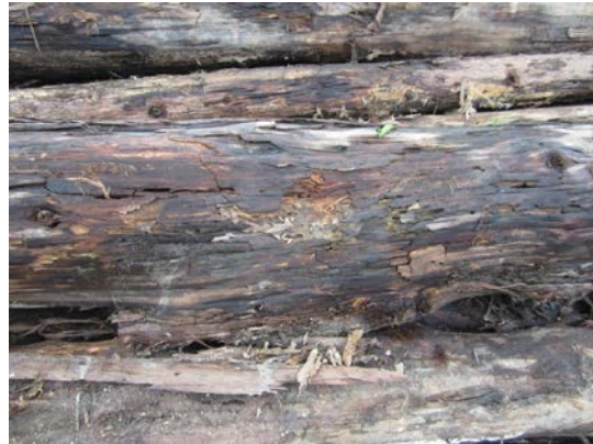
圖 20. 因連續下雨導致腐朽情形更惡化
