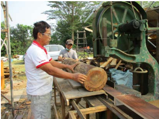
圖 69. 於木工廠以帶鋸將邊材鋸除作為固定底部
