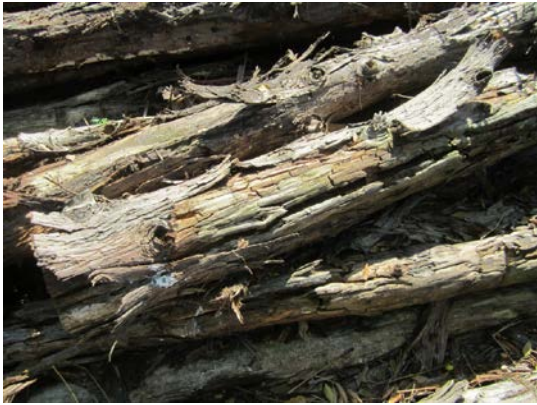
圖 33. 小徑木放置 3 個月後表面樹皮腐爛加劇
