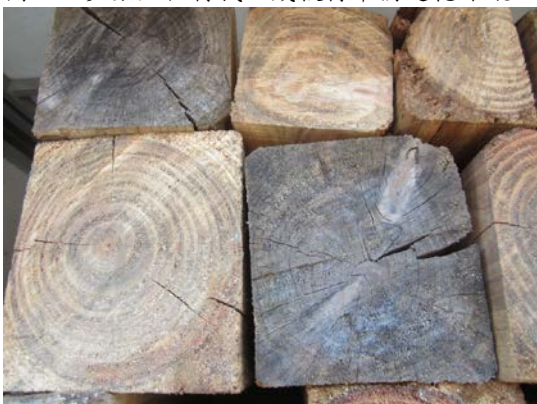
圖 31. 乾燥後之柱材乾裂嚴重
