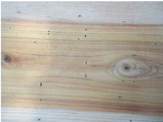
圖 37. 裁切的板材可見許多蟲蛀痕跡
