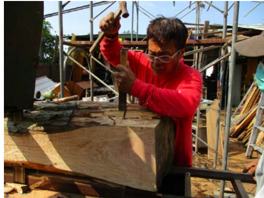
圖 76. 木工師傅以鑿刀將多餘部分鑿除以利木材通過帶鋸
