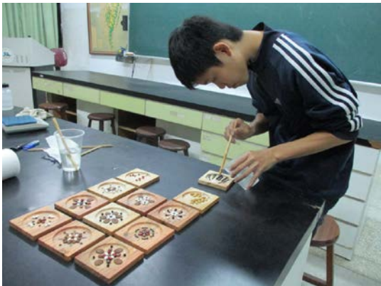
圖 109. 將混合之環氧樹脂緩慢倒入種實杯墊中
