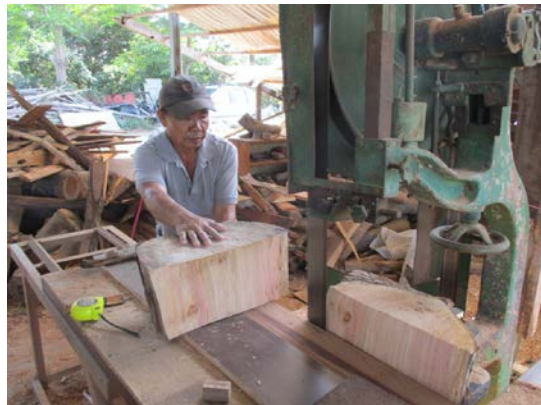
圖 86. 以帶鋸機將紅檜根張基部鋸切成木製燈底座
