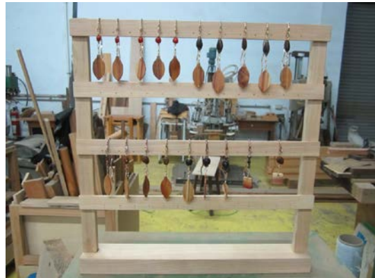
圖 56. 台灣杉薄片製作的書籤夾亦需浸漆保護
