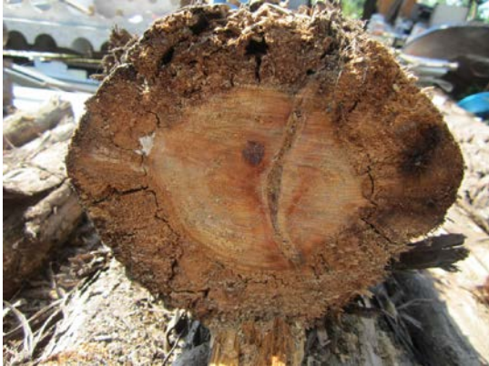
圖 35. 橫切後可見邊材均已腐朽無法利用
