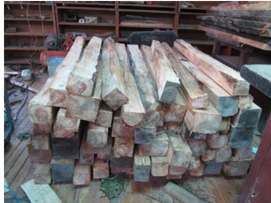
圖 28. 將較大徑木裁切掉腐朽邊材後僅剩之心材準備送乾燥廠
