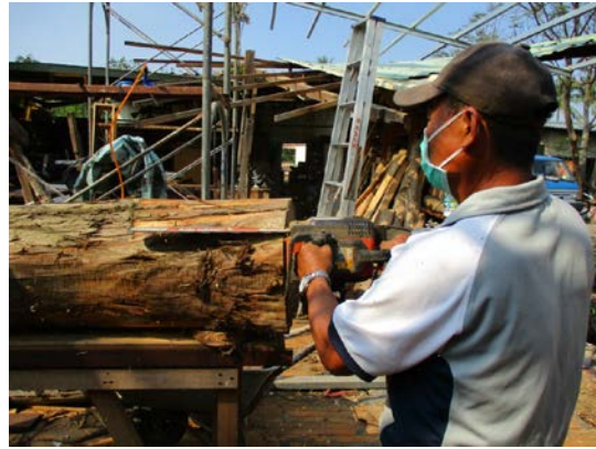
圖 74. 帶鋸高度有限所以需以鏈鋸鋸除根張處
