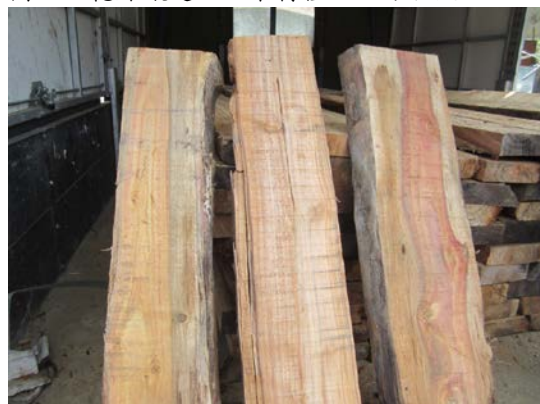
圖 32. 較大徑木之厚板材邊材仍有腐朽
