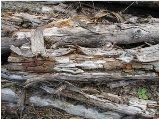
圖 65. 2016 年 12 月時台灣杉小徑木多已腐朽不堪使用
