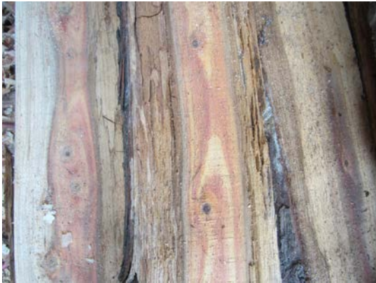
圖 27. 有些木材雖較乾燥且紋路美但邊材多已腐爛
