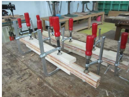
圖 44. 將木材切成 0.3cm 薄片後用夾具膠合拼接
