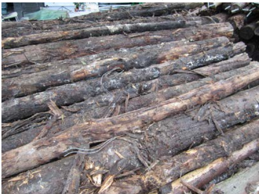
圖 15. 許多小徑木長期堆放導致表面潮濕腐爛
