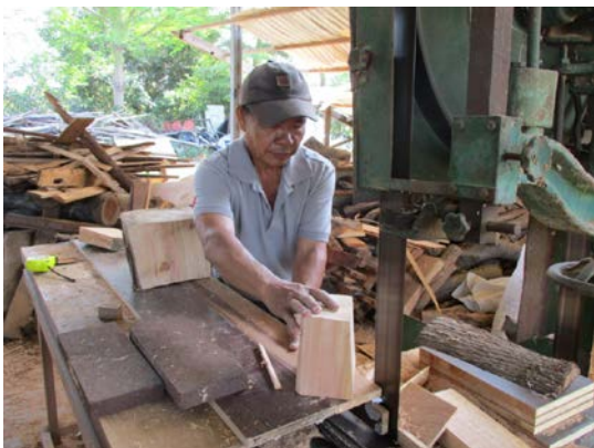
圖 87. 以帶鋸機初步鋸切紅檜木製燈之底座
