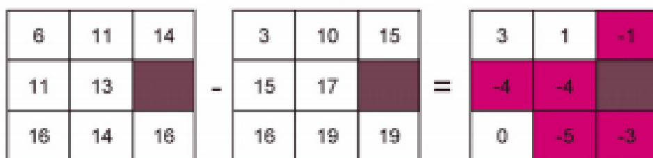
圖 42 前後期地形變化之土方量計算示意圖
