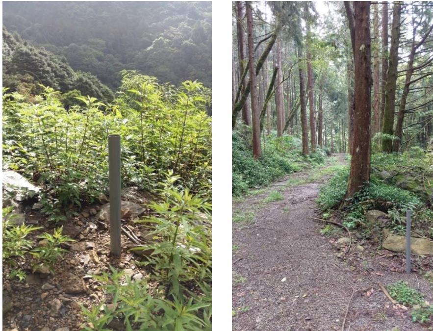
圖 38 作業道監測掃瞄之控制點設置
