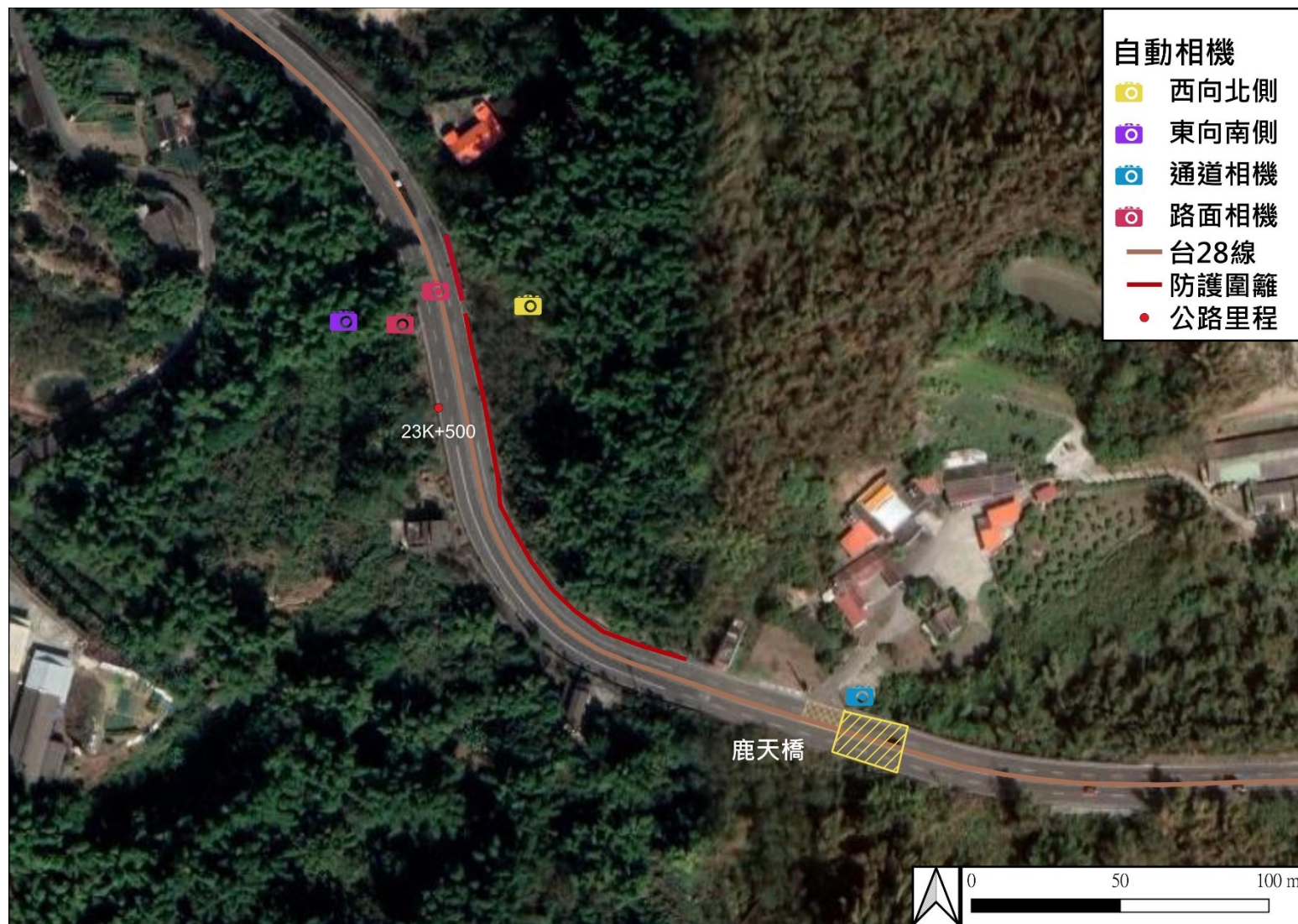
圖 7、鹿天橋橋下動物通道、防護圍籬缺口、夜間拍攝路面監測相機及防護圍籬位置
